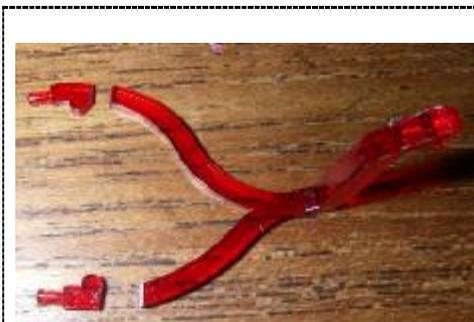
テールライト導光パーツを切断して、赤色 **LED** (透明) と遮光テープを使用して固定します。
