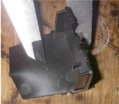
スピーカー取付け位置のセンターをケガキます。後ろ側から14mmの左右の中心をセンターとしてケガキます。座繰りカッター20mm（ホームセンターで¥700-程度）で穴あけを行います。ドリルドライバーかハンドボール等で加工します。加工材を厳重に固定する必要があります。くれぐれも、怪我に気をつけて、慎重に行ってください。中心に下穴をあけてから、作業を進めてもよいでしょう。
