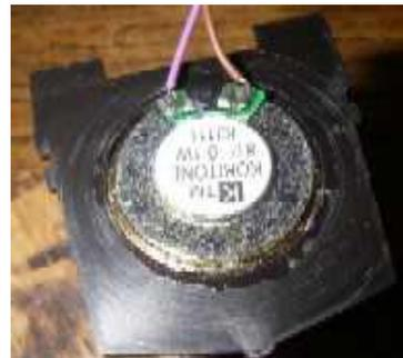
スピーカーをはめ込み瞬間接着剤を回りに染みこませて固定します。隙間があると音が回り込んで効率が悪くなり小さくなります。内側はツライチになるようにしてください。スピーカーがはみ出すと配線等と干渉し、ビビリが発生する可能性があります。
