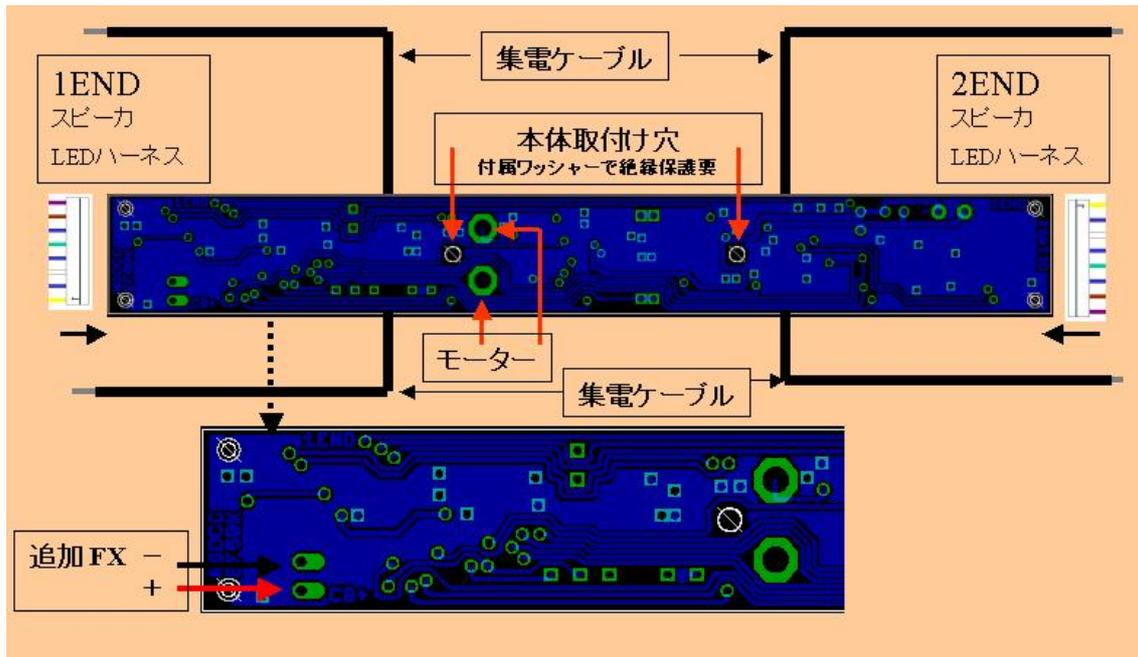
組込み前テストでは、集電ケーブルが不用意に他の部品に接触して短絡しないように細心の注意を払ってください。また、2組のコネクタを接続しておかないと、スピーカから音は出ないのでご注意ください。
