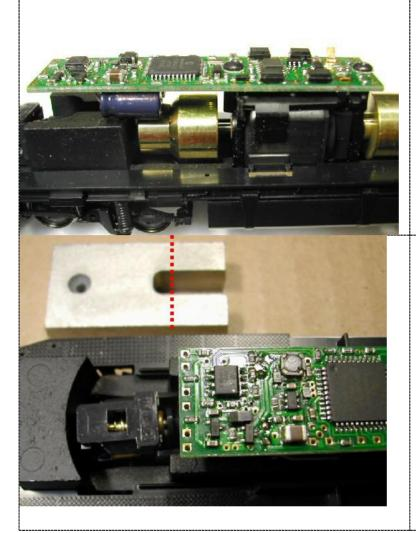
※本製品では、元のライト 基板の位置に2本のビスで 取り付けかつ、モータ結線ま での実現です。線路電源の 接続、スピーカの取付け及 び配線は、指定してません、 各自工夫してください。
